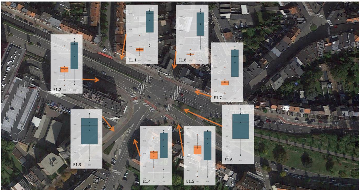
Figuur 26 – Kaartweergave van de evolutie van de distributies van het totaal aantal fietsers geteld per dag per tellus in Leuven.
