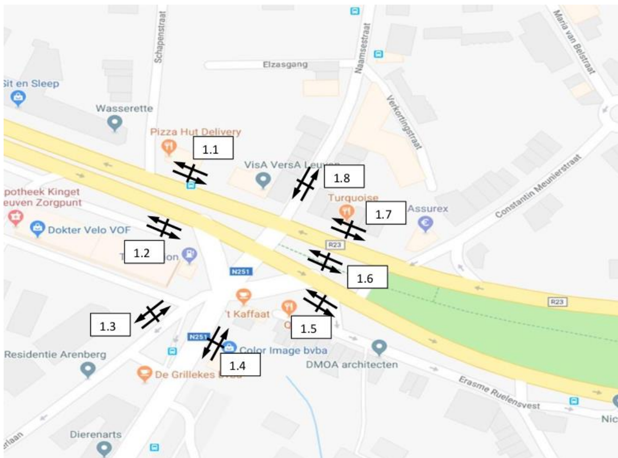
Figuur 21 – Tellocaties op het 4-takskruispunt R23 x Naamsestraat x Naamsesteenweg in Leuven.
